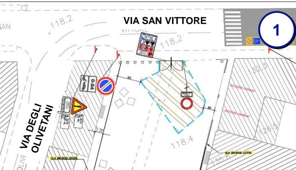
PLANIMETRIA VIABILITA' LOCALE - FASE2 (COMPLETAMENTO SCAVO ARCHEOLOGICO CON RECINZIONE MOBILE TIPO ORSOGRILL) SCALA 1:250
